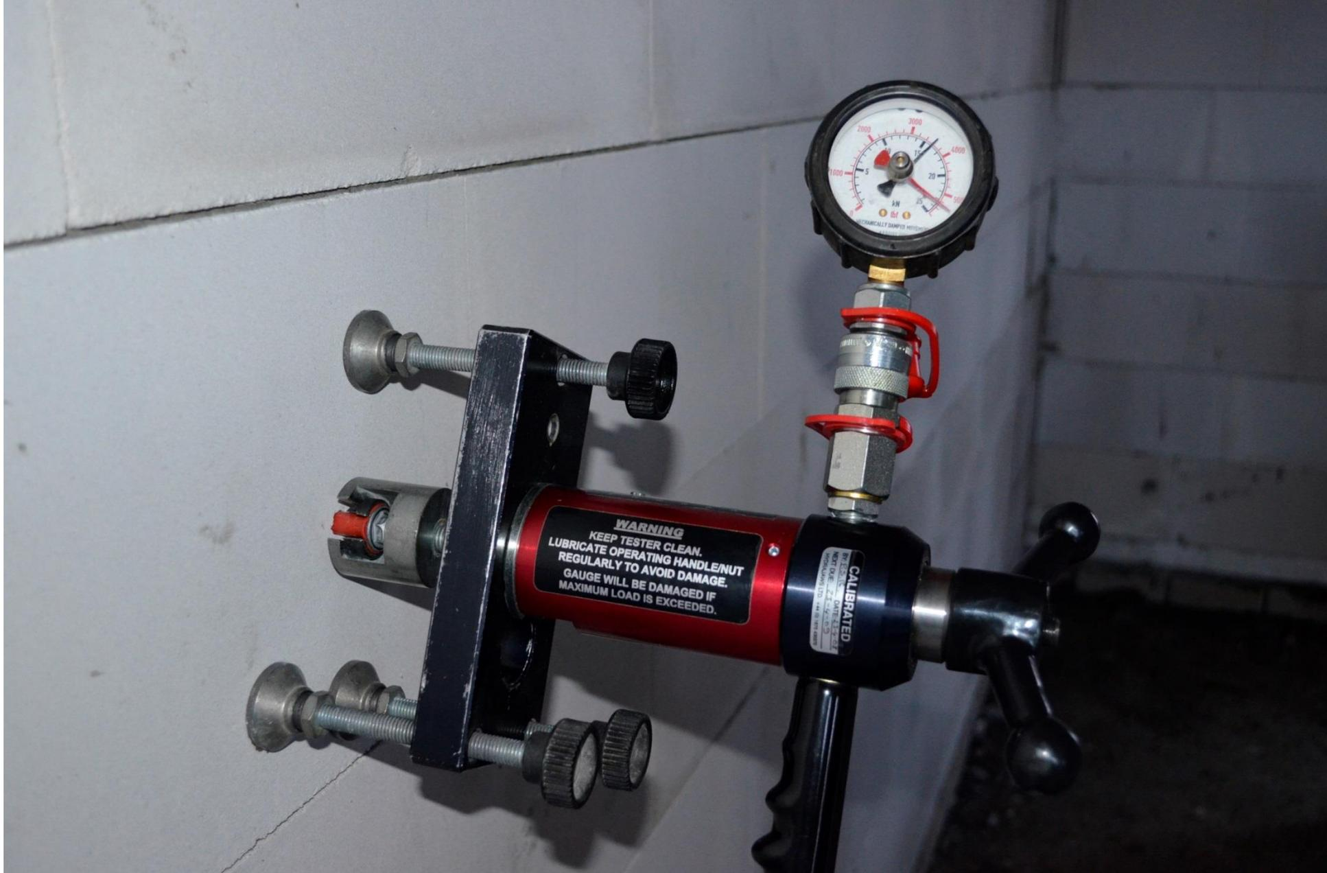
Предельное показание манометра – 2,5 тонны, смещение пластикового дюбеля не достигнуто ни на одном из 15 образцов
