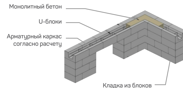
Схема изготовления армопояса из U-блоков «ЭКО»
